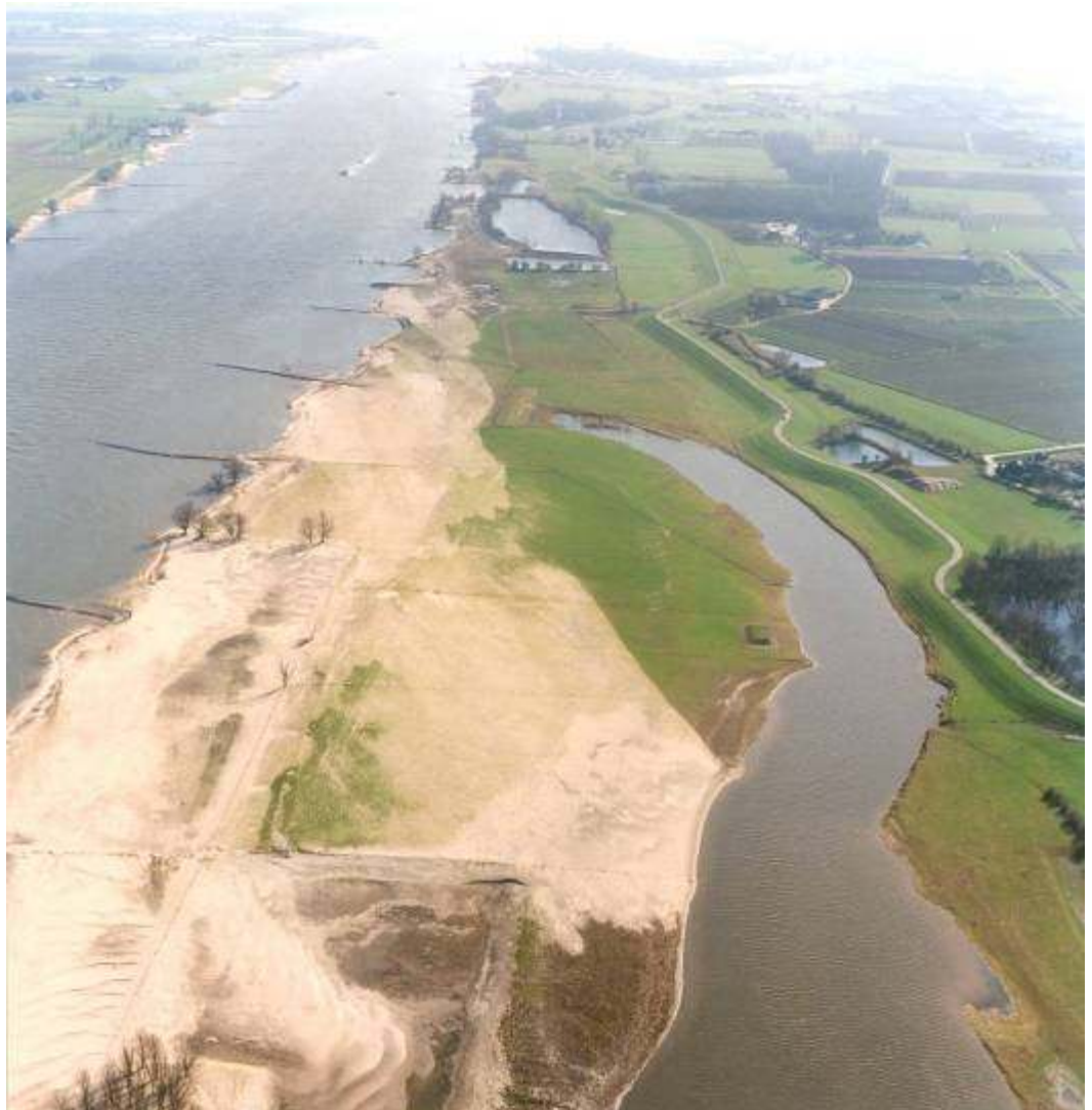
Figuur 5 Zandafzettingen op de Ewijkse Plaat na het hoogwater van december 1993 (foto Rijkswaterstaat).
